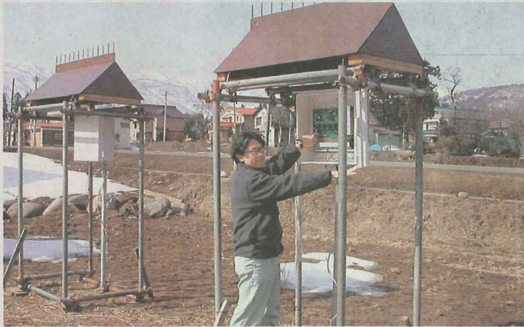
着雪防止に効果的な振動を探る実験装置—妙高市
